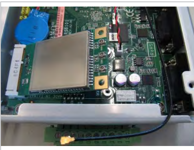
Fig. 17: Retirer le module GSM.
