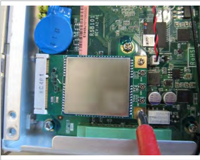
Fig. 16: Dévisser les vis sur le module GSM.
