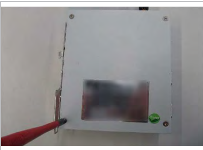
Fig. 21: Fermer le boîtier de la passerelle.
