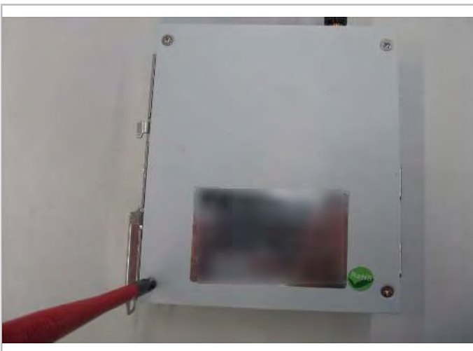
Abb. 21: Gehäuse des Netzkopplers schließen.
