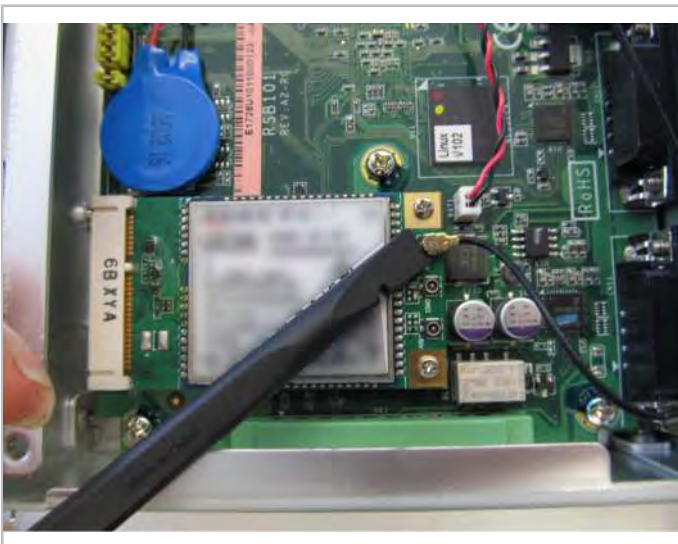
Abb. 15: Antennenkabel vom GSM-Modul entfernen.
