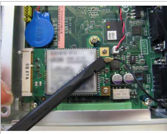
Fig. 15: Retirer le câble d'antenne du module GSM.
