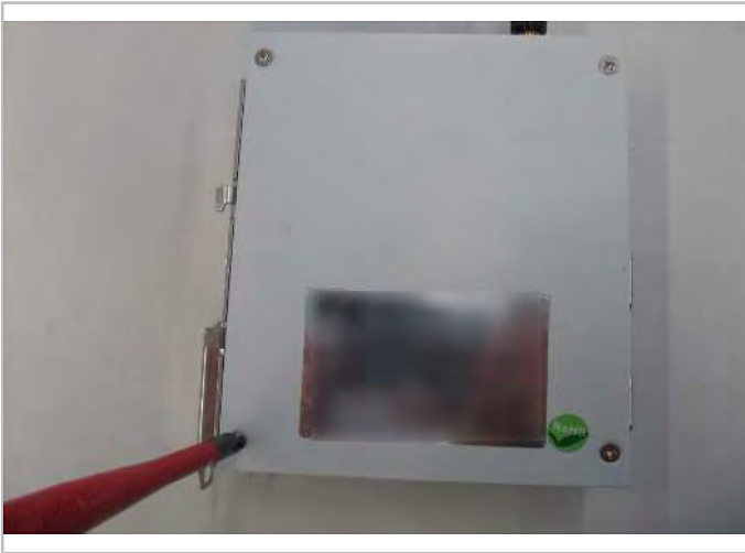
Fig. 14: Ouvrir le boîtier de la passerelle à l'aide d'un tournevis.
